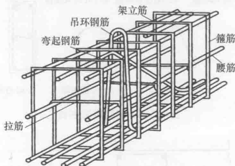
图 1-6 架立筋、腰筋等在钢筋骨架中的位置
