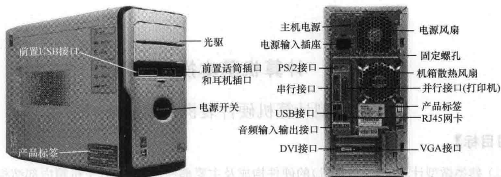
图 1-2 微机主机箱前面板和后面板外观图
