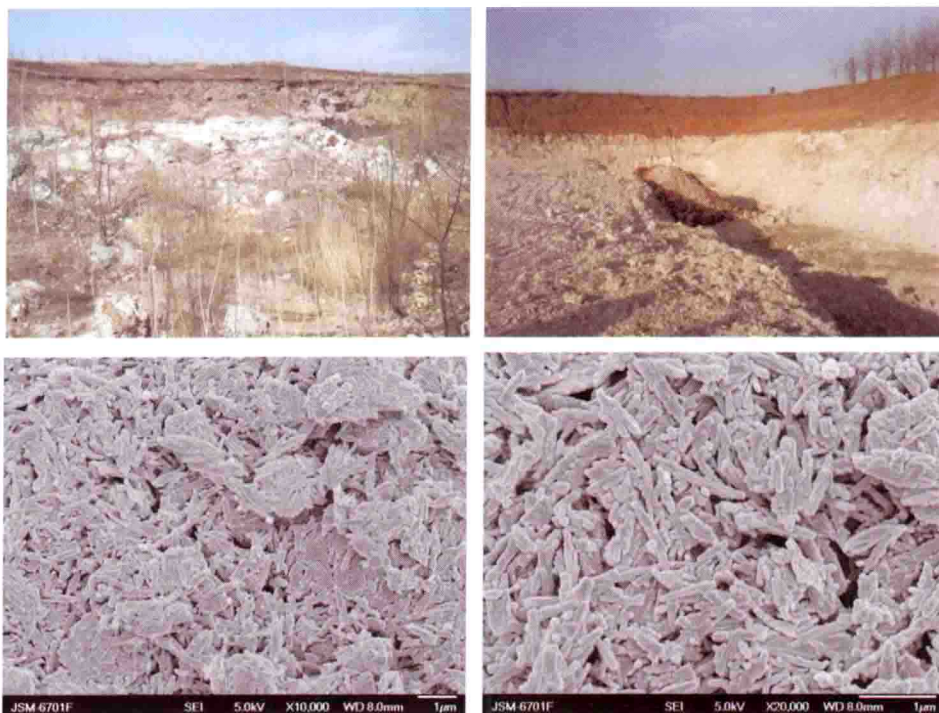
图 1-25 高家洼凹凸棒石黏土矿及其 SEM 图片
