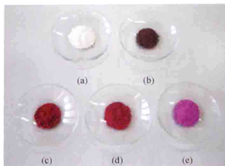
图 1-75 凹凸棒石(a)、甲基紫(b)、凹凸棒石+2% 甲基紫研磨后(c)、140℃ 加热后(d)和在乙醇中萃取后(e)的数码照片 [246]
