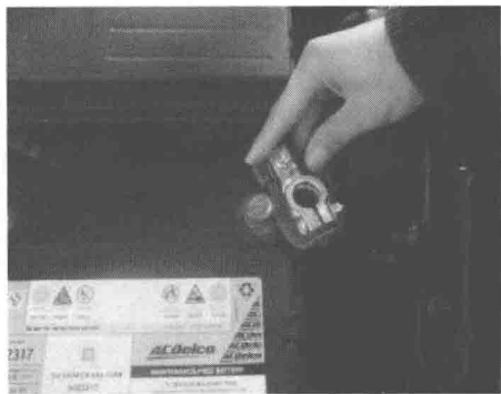
图1-13 从正极上取下正极电缆
