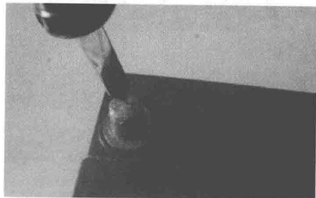
图1-23 将负极测量头连接在负极桩头上
