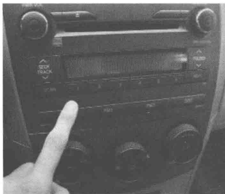
图1-7 确认空调、音响关闭
