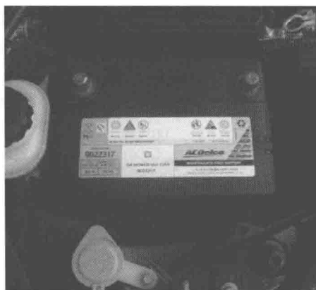
图1-30 将蓄电池平放在底座上
