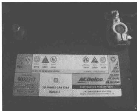
图1-31 安装正极电缆夹
