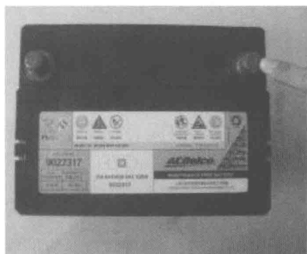
图1-17 检查正、负极桩头是否有污垢或氧化物
