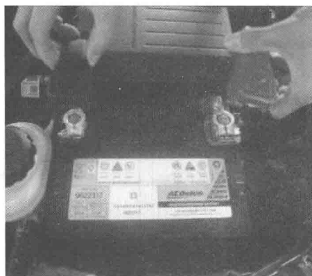
图1-9 取下蓄电池防护罩
