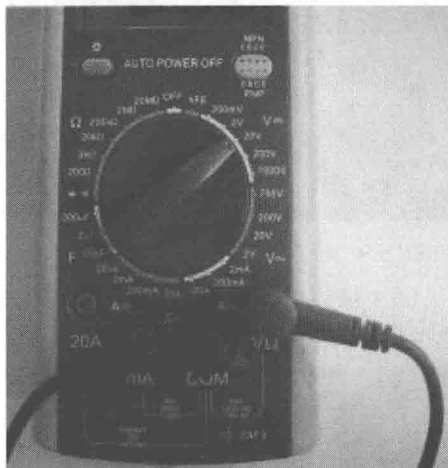
图1-19 将挡位置于直流电压20V挡位
