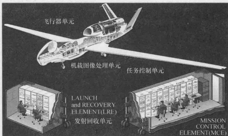
图 1-4 “全球鹰”无人机系统的飞机和地面站
