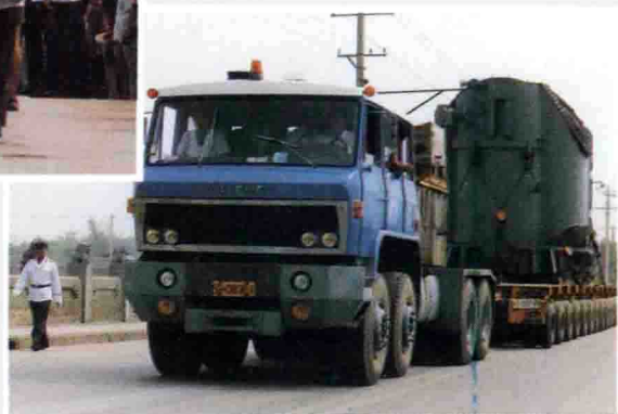
运输由苏联引进的 500 千伏房山变电站主变压器 途径闻名中外的芦沟桥
