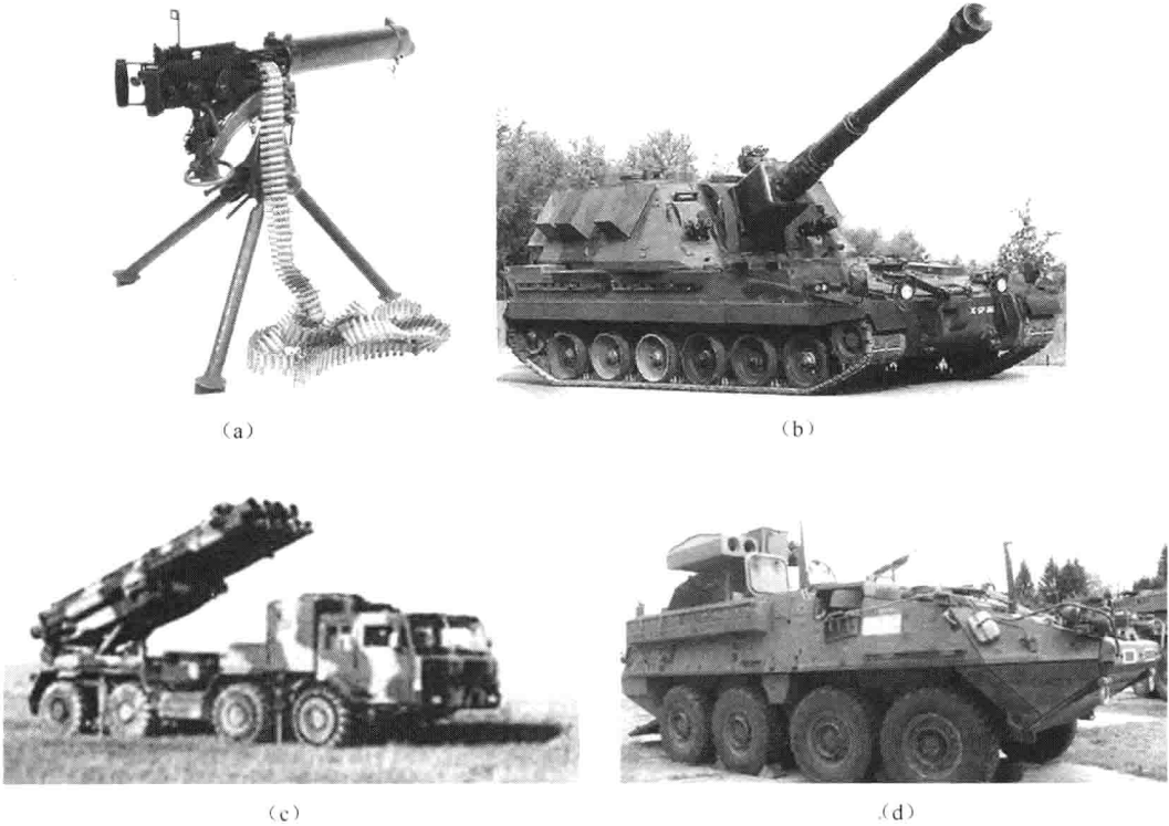
图 1.4 典型武器发射系统 (a) 机枪; (b) 自行火炮; (c) 火箭炮; (d) 反坦克导弹发射车。
