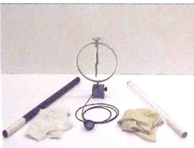
玻璃棒经丝绸摩擦后带正电， 橡胶棒由毛皮摩擦后带负电
