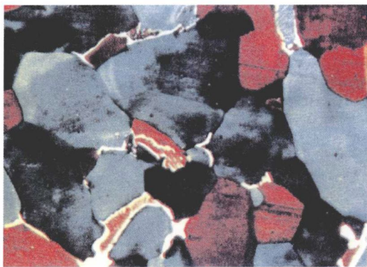
彩图 2 低碳钢,用 3 号试剂侵蚀 500×
