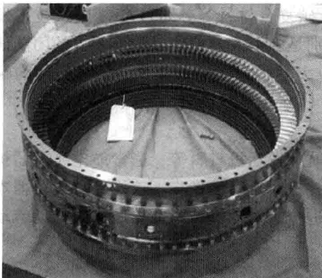
图 1-2 阻燃钛合金 Ti40 发动机压气机机匣零件
