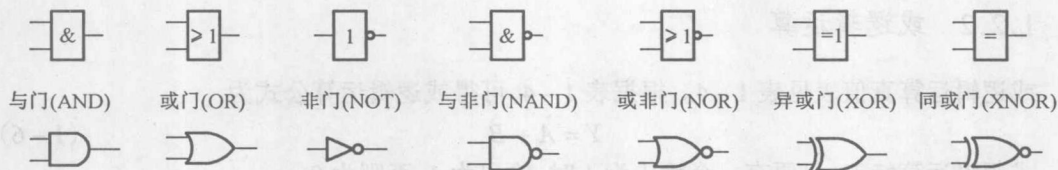
图 1-1 几种常用的门电路图形符号
