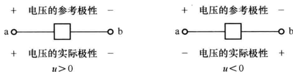
图 1-4 电压参考极性和实际极性的关系
