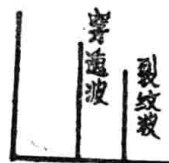
图 9 裂纹测深波形
