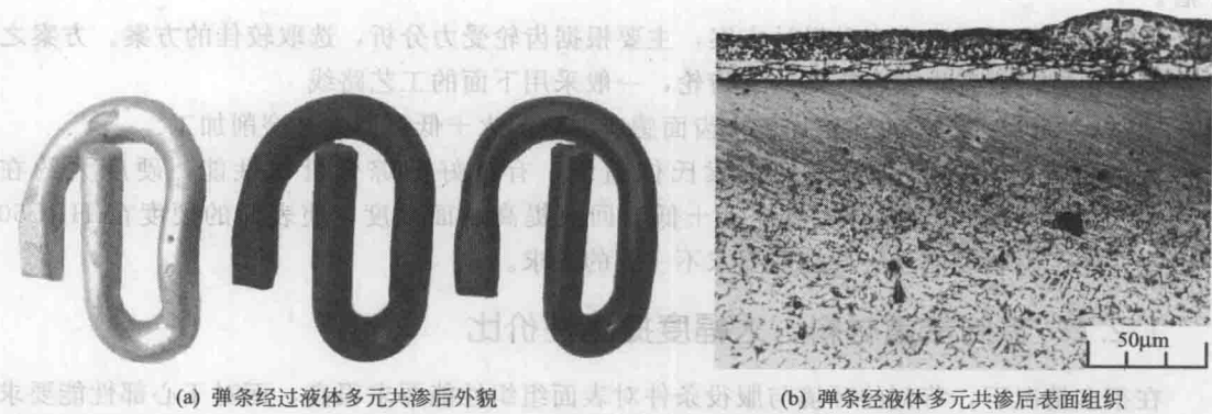
图 1-7 铁路弹条经过低温液体多元共渗后外形与表面组织照片
