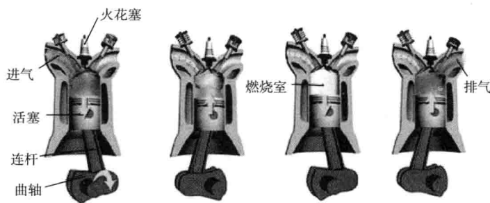
图 1-1 内燃机的工作原理
