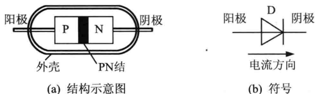
图 1.7 二极管的结构示意图与符号
