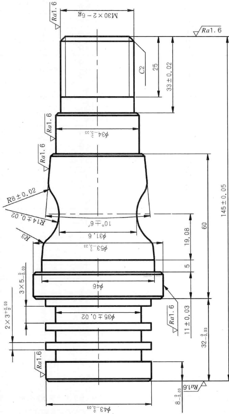
考核要点：工件调头加工工艺，外螺纹加工和检测。
