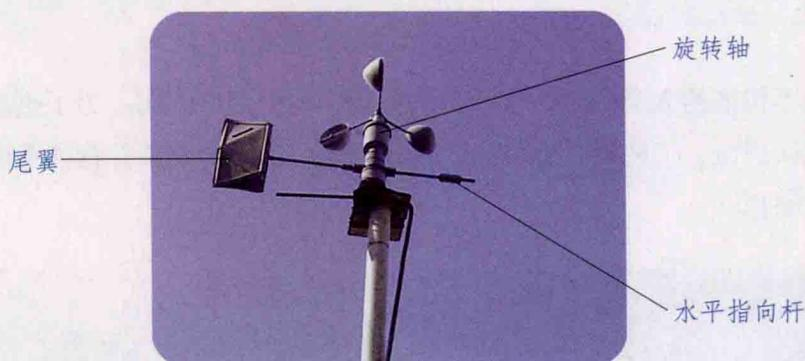
在风的作用下，尾翼产生的旋转力不仅使风向标转动，而且还可以通过不断调整指向杆来指示风向。
