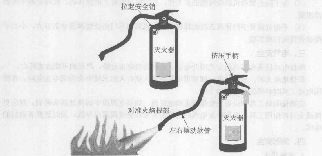
图 1—2 灭火器的使用方法
