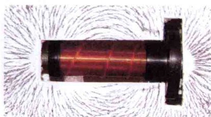
铁粉显示的线圈的磁力线（有铁芯）
