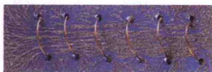
铁粉显示的线圈的磁力线（无铁芯）
