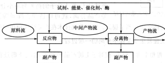
图 1-1 化工产品反应及分离的典型过程
