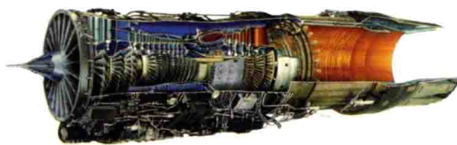
涡轮风扇发动机剖视图
