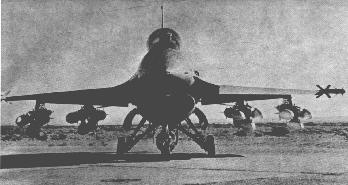
(上) F-16 戰鬥機的正面。圖中可見飛機的翼梢掛有 AIM-9L 「響尾蛇」式空對空導彈，每邊機翼翼下各設有兩副裝上炸彈的三聯彈射彈架。(下) F-16 所配備的威斯汀豪斯 X 波段多波形脈沖多普勒雷達，這種雷達可提供四種空對空工作方式和七種空對地工作方式。空對空的工作方式包括：①上視，用作在飛機水平線以上的搜索和追蹤；②下視，用作在飛機水平線以下的搜索和追蹤；③空戰，用以在格鬥交戰中自動探測目標；④自動，用以自動選擇上視或下視。空對地工作方式包括：①空對地測距；②實波束地面地圖；③擴大實波束地圖；④多普勒波束加強；⑤定向無線電波；⑥凝像；⑦海面搜索。
