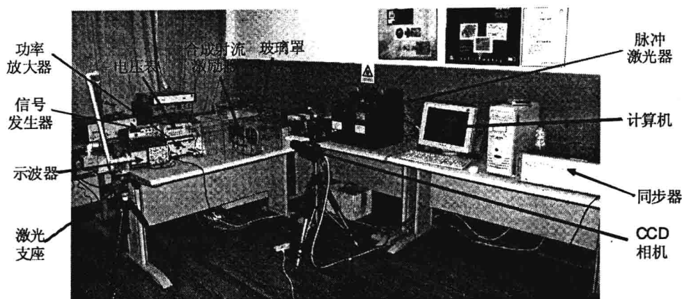
图3 合成射流 PIV 实验测试装置
