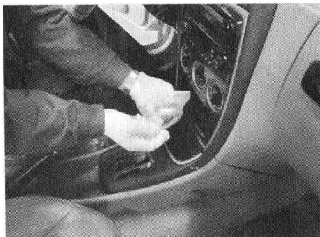
图 1-18 安装变速杆套
