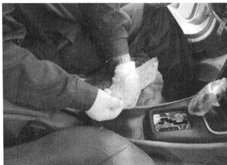
图 1-19 安装驻车制动器操纵杆套
