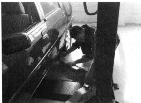
图 1-24 安装举升机支撑臂至车身举升处
