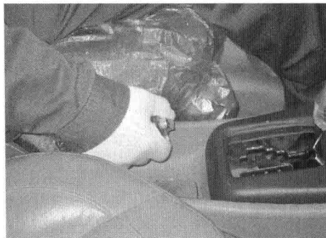
图 1-20 拉紧驻车制动器操纵杆
