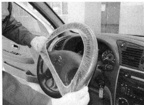
图 1-15 安装转向盘套
