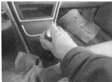
图 1-21 变速杆置于空挡或驻车挡位
