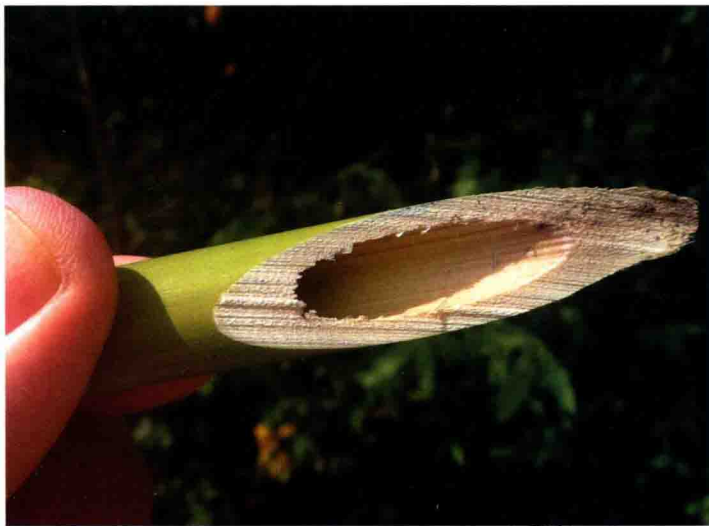
↓ 竹茎秆细部图 展示出坚硬的外层和中空的内部。
