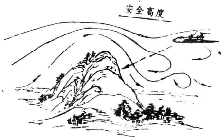
飞机被乱流带入背风坡的旋涡中
