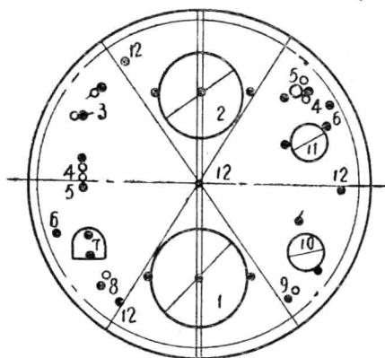
图2 井筒内施工设备布置图
