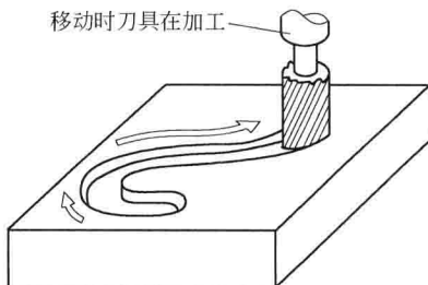
图 1-7 轮廓控制数控机床加工示意图
