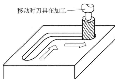
图 1-6 直线控制数控机床加工示意图
