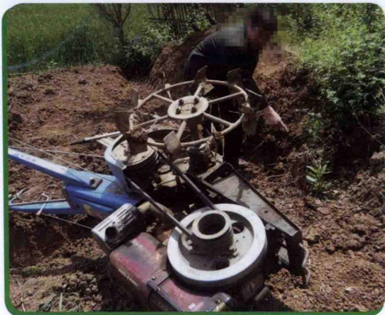
**事故经过：**2012年4月27日，湖北省南漳县张某无证驾驶鄂06×××××号手扶拖拉机，在自家田中进行犁地作业后，在转移地块时，由于地面高低不平，张某操作失误，致使手扶拖拉机侧翻，张某躲避不及，造成其右脚腕部严重骨折，脸部擦伤。
