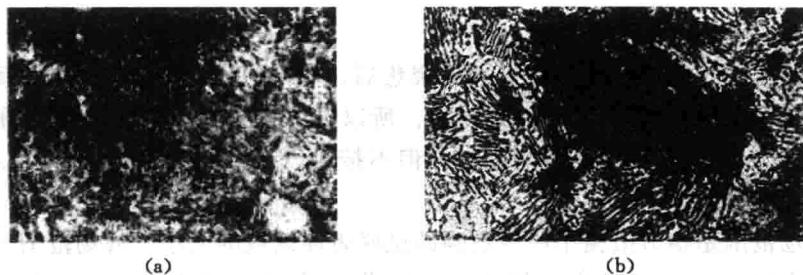
图 1-4 物镜的数值孔径对同一组织分辨情况的对比
