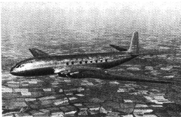
图 0-5 20 世纪 40 年代末，首架考迈特喷气式飞机矩形窗是一个致命的设计瑕疵
