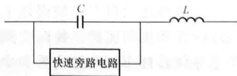
图 1-5 串联谐振型限流器原理示意图
