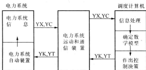
图 1-1 电力系统综合自动化系统工作模式图
