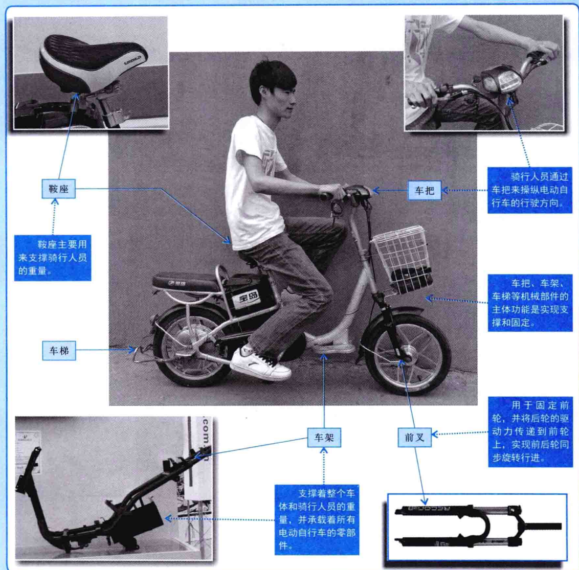
【电动自行车承重部分的结构】
