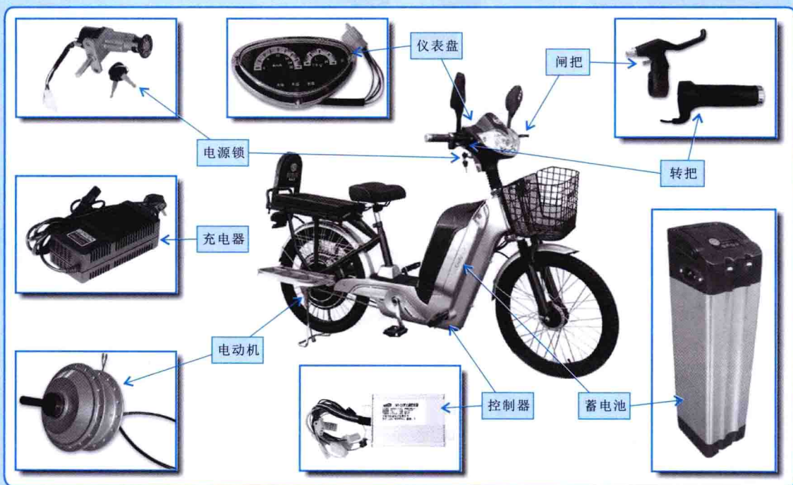
【电气系统的结构】
