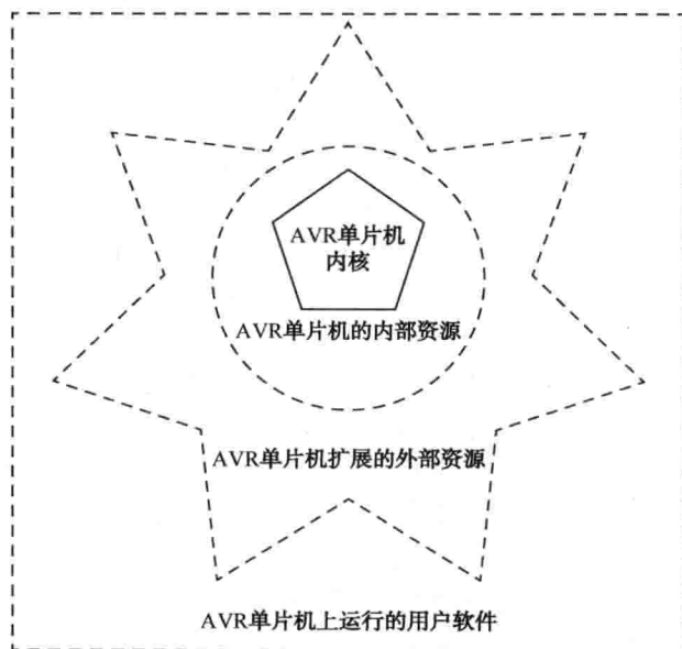
图 1.1 AVR 单片机应用系统结构
