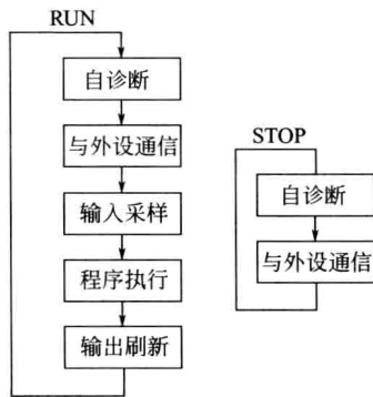
图 1-5 PLC 的扫描工作过程
