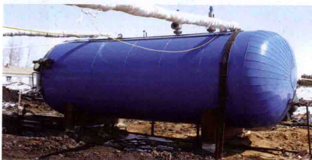
水稻植质钵育秧盘圆式蒸汽干燥装置（2011 年）
