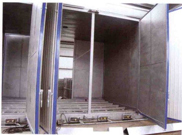
水稻植质钵育秧盘厢式蒸汽干燥装置（2011 年）
