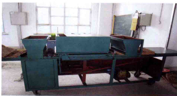
第Ⅰ代水稻植质钵育秧盘型孔式播种机（2008年）
