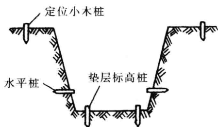
图 1-4 基坑定位高程测设示意图
