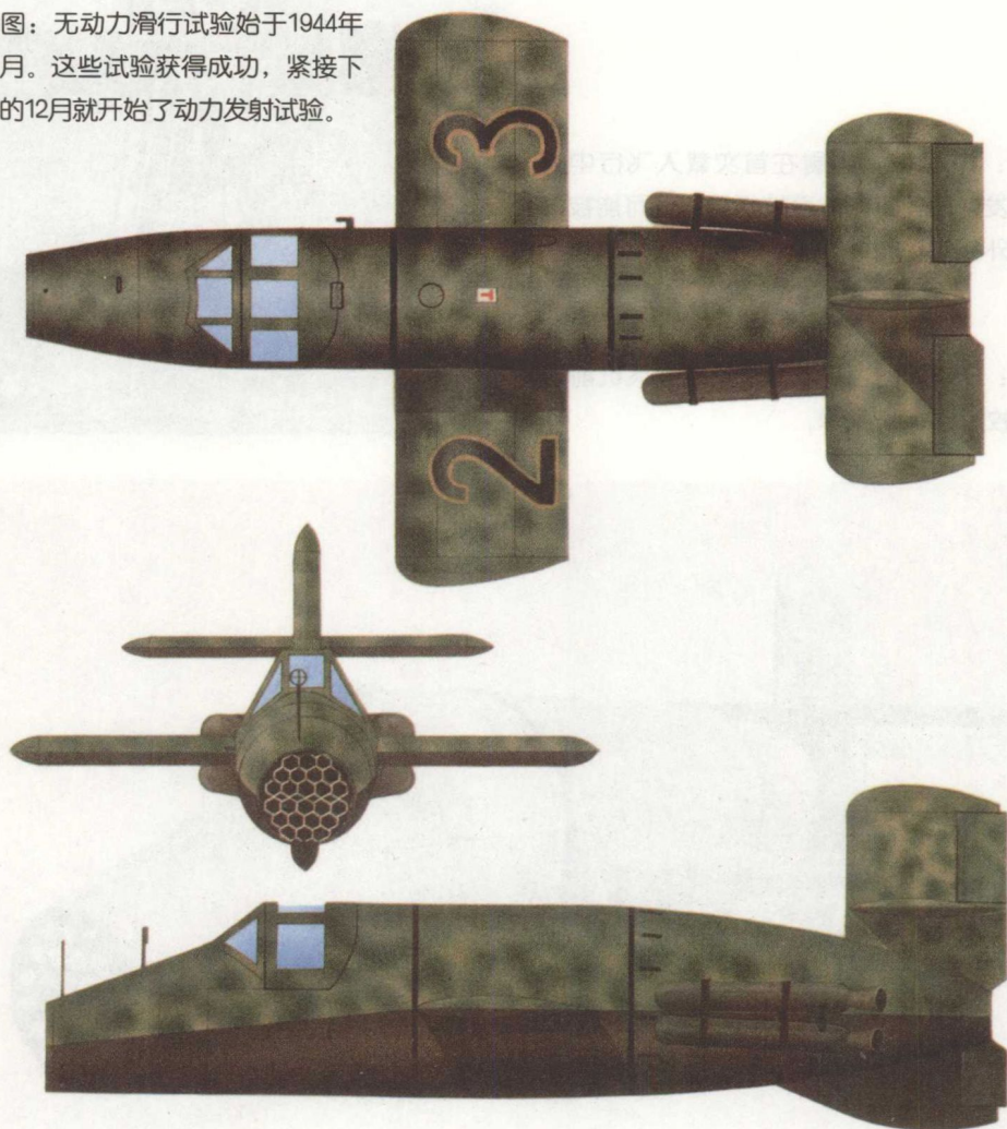
下图：“蝮蛇”被认为是接近高空截击机的最简单设计机型。机头处的火箭阵列是它唯一的武器。
