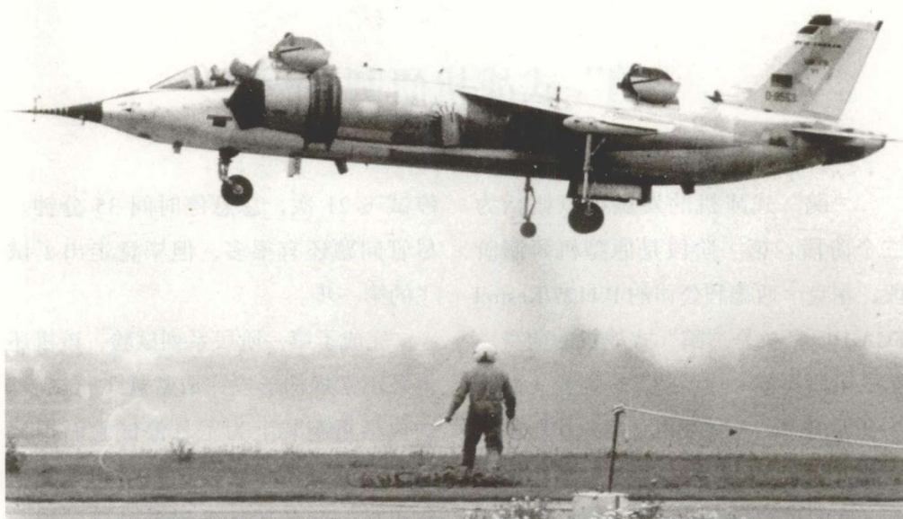
上图：认为“鹞”式飞机不够尖端，德国VFW-FOKKER公司与其合作伙伴共同建造了一款VAK-191飞机，它装有罗尔斯·罗伊斯公司生产的RB.193发动机，两个升力发动机和小型机翼，以及内置武器舱（在设计中，此飞机为低空攻击机）。
