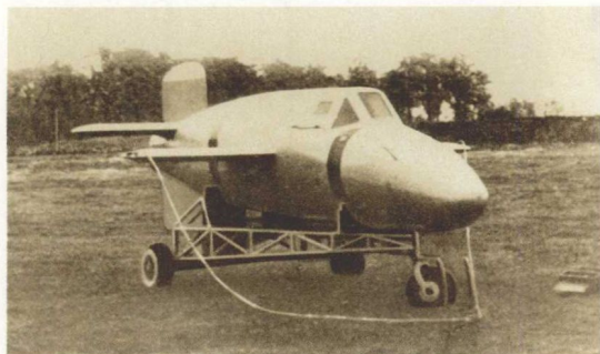
下图：“蝮蛇”被认为是接近高空截击机的最简单设计机型。机头处的火箭阵列是它唯一的武器。
