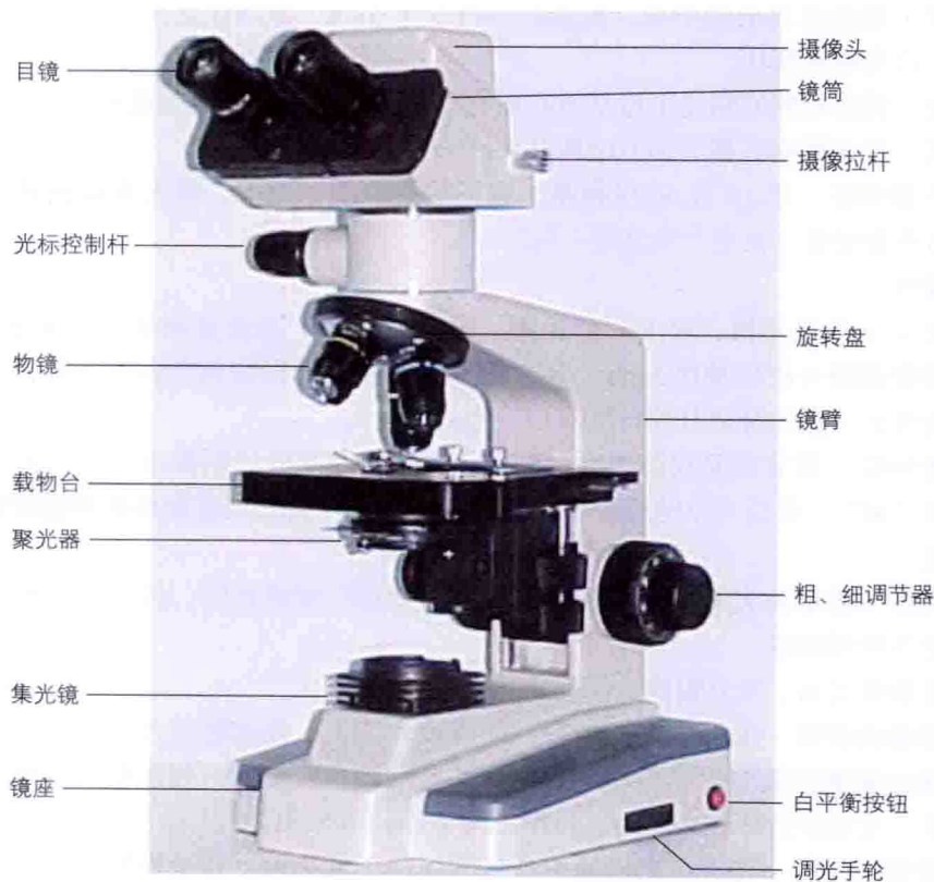
图 1-1 数码显微镜构造图
