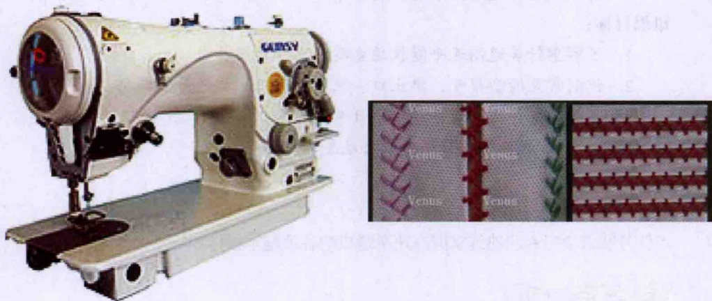
图2 单针人字缝高速平缝机及其缝迹
