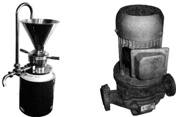
图1-4 立式电动机应用示例
