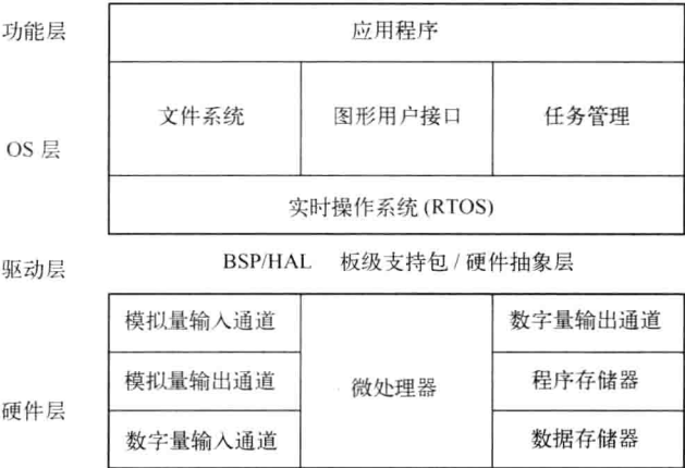
图 1-1 嵌入式系统分层结构
