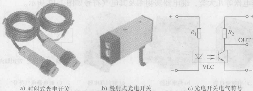
图 1-11 光电开关实物图及其电气符号
