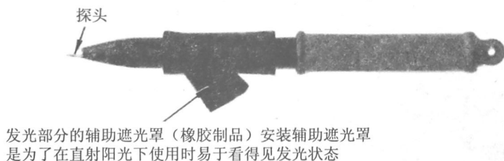
图 1.5 氖管式高压验电器
