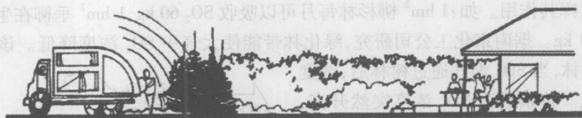
图 1.2 密植灌木能减弱装货、卸货的噪声
