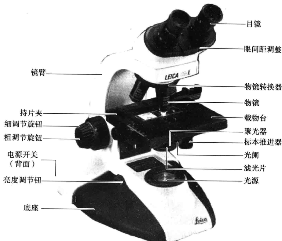
图 1-1 普通光学显微镜(双筒)结构示意图
