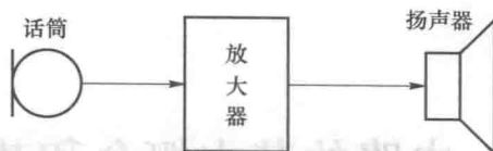
图 1-2 扩音机电路示意图
