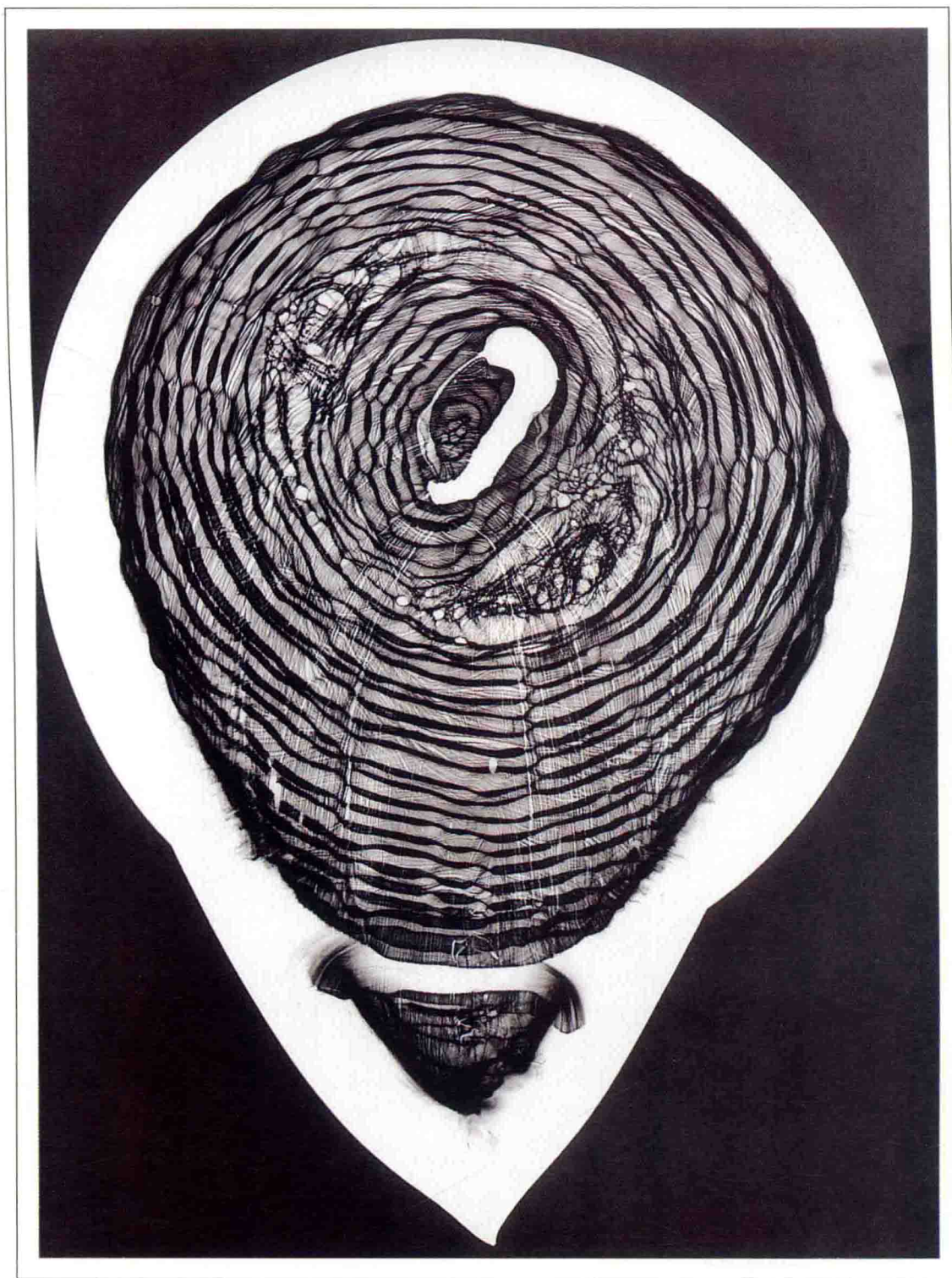
图12 玻璃内部与其表面本质关系的插图。当玻璃的表面变硬，与较热的、较为流动的内部形成对比，表现为同心的皱折表面冻结，以及从吹制管上截取玻璃时留下的修剪痕迹。任何热融玻璃的制作工艺都必须将这些特殊的材料行为特征作为最根本的考虑事项。
